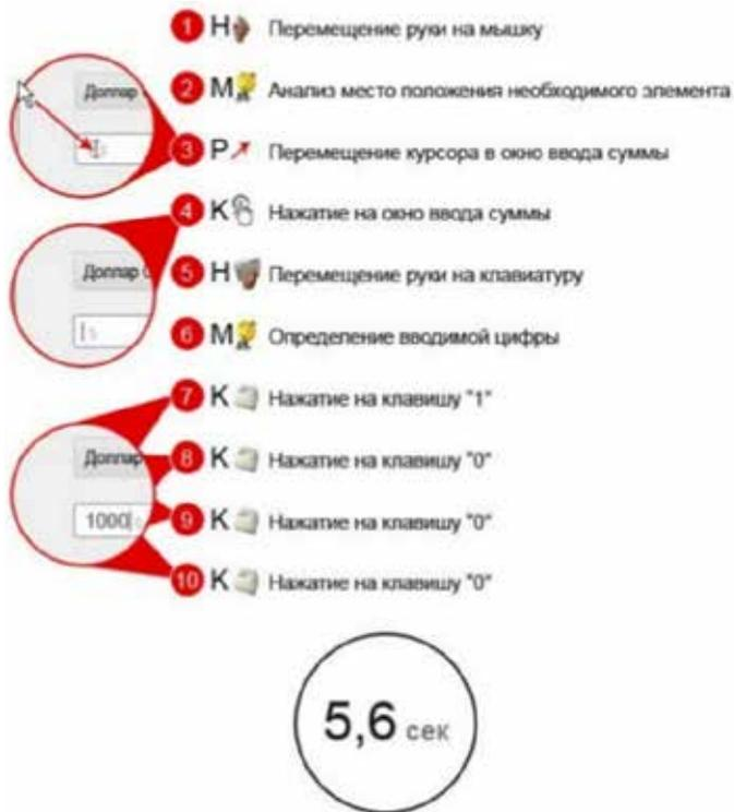
Рис. 2.13. – Расчет по модели KLM-GOMS виджета конвертации валют-2
